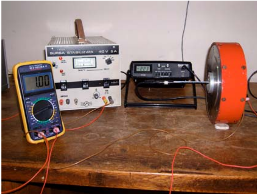
Figura 11 - Aranjament experimental pentru măsurarea câmpului magnetic în lentila L2
