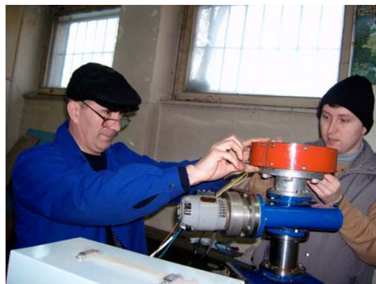
Figura 4 - Montajul cilindrului Faraday la baza lentilei L2; 4a -cilindrul Faraday la fața superioară a tronsonului T3; 4b - montajul tronsonului T3, și a lentilei L2
